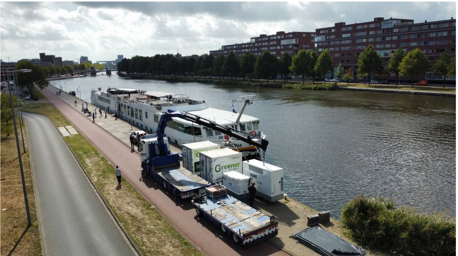
Walstroom met batterijen van Greener Power Solutions
